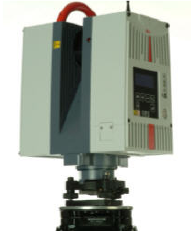
Laserscanner-Messkopf Leica HDS6000
